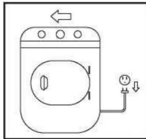
KROK 4: Używając szczotki do usuwania kłaczków i odkurzacza, wyczyść tylną część suszarki, jak pokazano na rysunku. oraz okolic.
