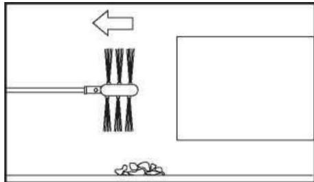
**STEG 9:** När systemet har rengjorts, ta bort tejpen eller klämman från den yttre spjället och returnera alla jalusier eller skärmar som tagits av. Anslut ventilen tillbaka till torktumlaren med rätt material och skjut tillbaka torktumlaren på plats. Se till att torktumlaren är ansluten och slå på den. Kontrollera på utsidan av huset efter luftflöde från ventilationshuvuen. Om den är helt rengjord bör det komma en större volym luft ut ur ventilationshuvuen.
