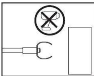
**STAP 6:** Bevestig de booradapter aan een accuboormachine.
