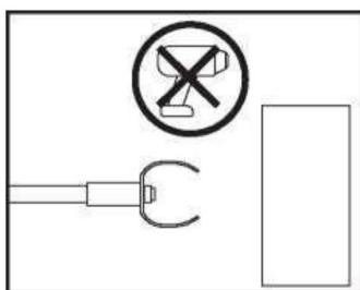
KROK 6: Podłącz adapter wiertarski do wiertarki bezprzewodowej.
