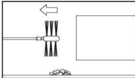
**FASE 9:** Una volta pulito il sistema, rimuovere il nastro o la clip dalla valvola esterna e rimettere a posto le persiane o gli schermi rimossi. Ricollegare lo sfiato all'asciugatrice con il materiale corretto e far scorrere l'asciugatrice al suo posto. Assicurarsi che l'asciugatrice sia collegata e accenderla. All'esterno della casa, controllare il flusso d'aria dalla cappa di sfiato. Se completamente pulita, dovrebbe uscire un volume d'aria maggiore dalla cappa di sfiato.
