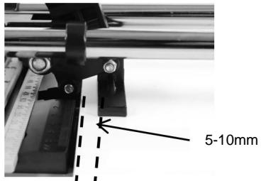
Tips: Nadat u de tegel hebt gebroken, kunt u het beste de hendel terugtrekken, zodat de breker 5-10 mm terug kan slaan. Dit is de beste positie om de tegel te breken.
