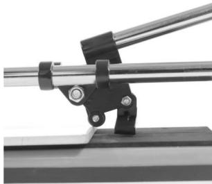
Schieben Sie das Rad nach vorne, indem Sie den Griff mit mittlerem Druck nach unten drücken.
