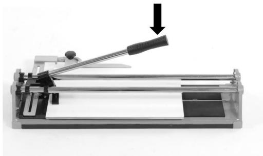
Nadat u de tegel hebt gescoord en de positie ervan niet hebt verplaatst, bevindt de breker zich iets in de voorste rand van de tegel en de voorste stop.
