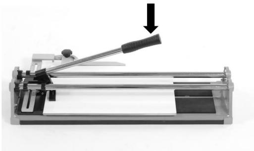
Después de marcar y sin mover la posición de la pieza, el interruptor queda ligeramente en el borde delantero de la pieza y tope delantero.
