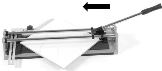
Coloque la baldosa en la máquina contra la regla de ángulo ajustada.
