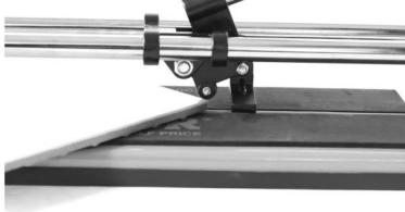
Schieben Sie das Rad nach vorne, indem Sie den Griff mit mittlerem Druck nach unten drücken.
