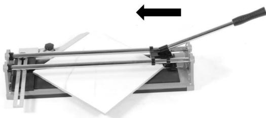
Położyć płytkę na maszynie, przystawiając ją do ustawionego kątomierza.
