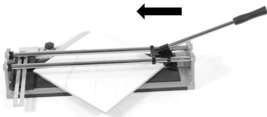
Leg de tegel op de machine tegen de ingestelde hoekliniaal.
