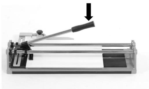
Po nacięciu i bez zmiany położenia płytki, łamacz znajduje się lekko na przedniej krawędzi płytki i zatrzymuje się z przodu.
