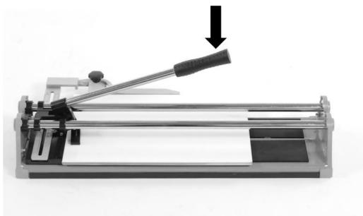
Efter poängsättning och utan att flytta brickpositionen är brytaren något i framkanten av brickan och främre stopp.
