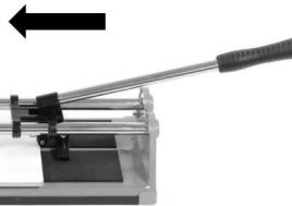
Coloque la rueda de corte en el borde trasero de la baldosa.
