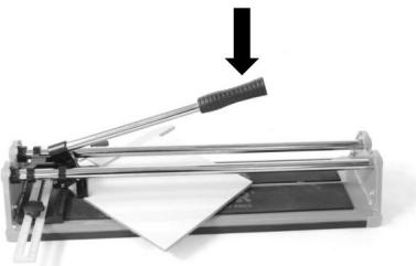
Después de marcar y sin mover la posición de la ficha, de modo que el interruptor quede ligeramente en el borde frontal de la baldosa y el tope delantero.
