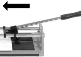
Setzen Sie das Schneidrad an der hinteren Kante der Fliese an.
