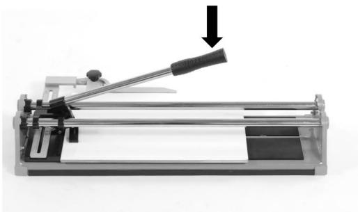
Après avoir marqué et sans déplacer la position de la tuile, le disjoncteur se trouve légèrement sur le bord avant de la tuile et en butée avant.
