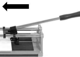
Umieść kółko tnące na tylnej krawędzi płytki.
