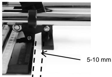
Tips: Efter poängsättning är det bättre att dra tillbaka handtaget för att låta brytaren gå något tillbaka 5-10 mm, det är den bästa positionen för att bryta plattan.
