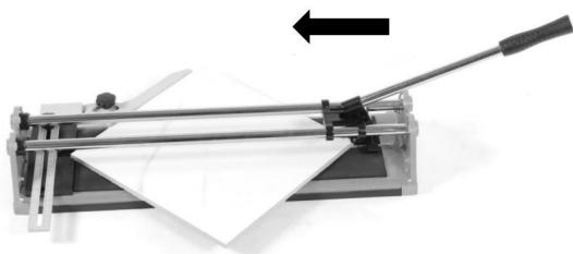
Placez le carreau sur la machine contre la règle d'angle réglée.
