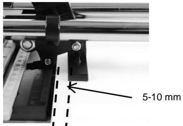
Tipps: Nach dem Ritzen ist es besser, den Griff zurückzuziehen, damit der Brecher 5–10 mm leicht zurückgehen kann. Das ist die beste Position zum Brechen der Fliese.
