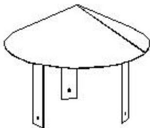
A) Cowl: \phi 135 \times 108 \text{mm}
