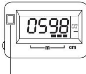
**Drücken Sie die Reset-Taste, um den Zähler zurückzusetzen**
