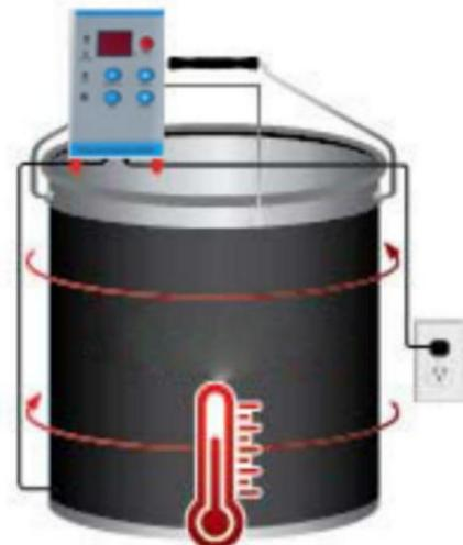
Inserire la sonda del controller tra la coperta e il secchio. Impostare il controller all'intervallo di temperatura desiderato.
