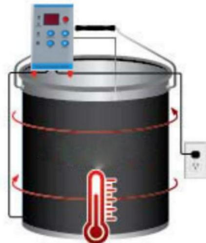
Führen Sie die Controller-Sonde zwischen der Decke und dem Eimer ein. Stellen Sie den Controller ein auf den gewünschten Temperaturbereich.
