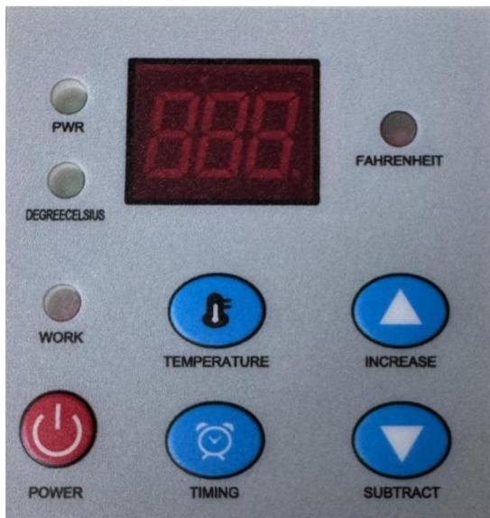
Réglage de la température : à la mise sous tension, vous pouvez appuyer directement sur les flèches « haut et bas » pour sélectionner la température que vous souhaitez régler, et appuyer sur le symbole de température pour confirmer.
