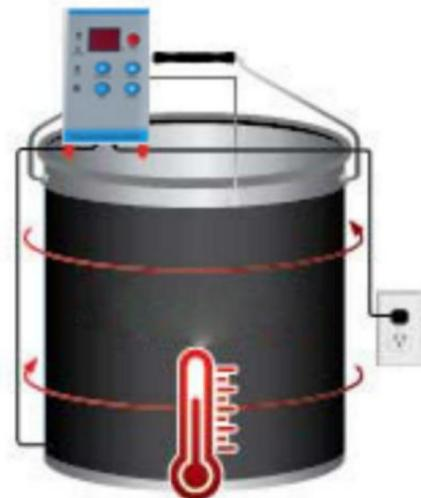
Insérez la sonde du contrôleur entre la couverture et le seau. Réglez le contrôleur.
