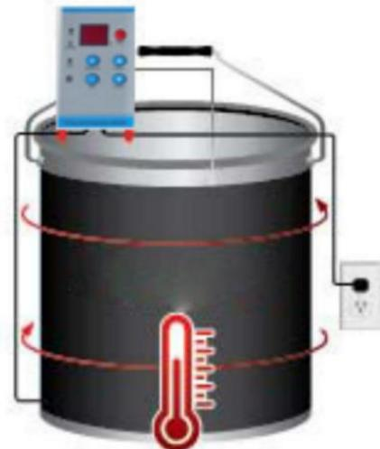
Inserte la sonda del controlador entre la manta y el balde. Configure el controlador al rango de temperatura deseado.
