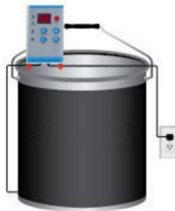
Si vous utilisez un contrôleur, branchez la couverture sur le contrôleur et branchez le contrôleur dans la source d'alimentation.
