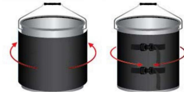
Otwórz opakowanie, sprawdź wtyczkę grzejnika, czy napięcie jest zgodne z aktualnym napięciem w gniazdku. Po sprawdzeniu owień grzejnik wokół butli gazowej i zaciśnij górną linkę uszczelniającą grzejnika. Przełoż pasek przez klamrę i pociągnij pasek aż do koca
