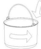
**Steg 3.** Sätt den avtagbara skålen i maskinen och vrid lätt runt skålen för att få den att passa bra med den fasta skålen (se bilden nedan).
