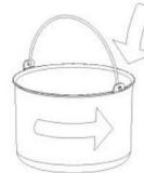
Paso 3. Coloque el recipiente extraíble en la máquina y gírelo ligeramente para que encaje bien con el recipiente fijo (ver imagen a continuación).
