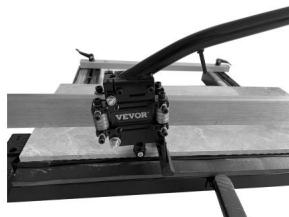
Coloque la rueda de corte en el borde trasero de la baldosa.
