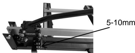
Tips: Na het scoren is het beter om de hendel terug te trekken om de breker iets terugtrekken 5-10mm, wat de beste positie is om breek de tegel.
