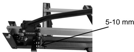
Tipps: Nach dem Einritzen ist es besser, den Griff zurückzuziehen, um die Unterbrecher wird 5-10 mm leicht zurückgezogen, was die beste Position ist, um zerbricht die Fliese.
