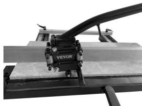
Umieść kółko tnące na tylnej krawędzi płytki.
