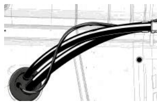
Dra rörledningar och ledningsnät in i hytten, gummihylsan är fäst vid öppningen
