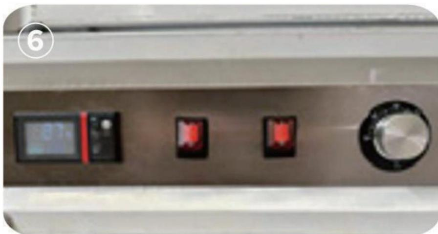
Stap 7: Temperatuurinstelling van de hoofdtemperatuur Beschrijving van de functie van het bedieningspaneel van de thermostaat.
