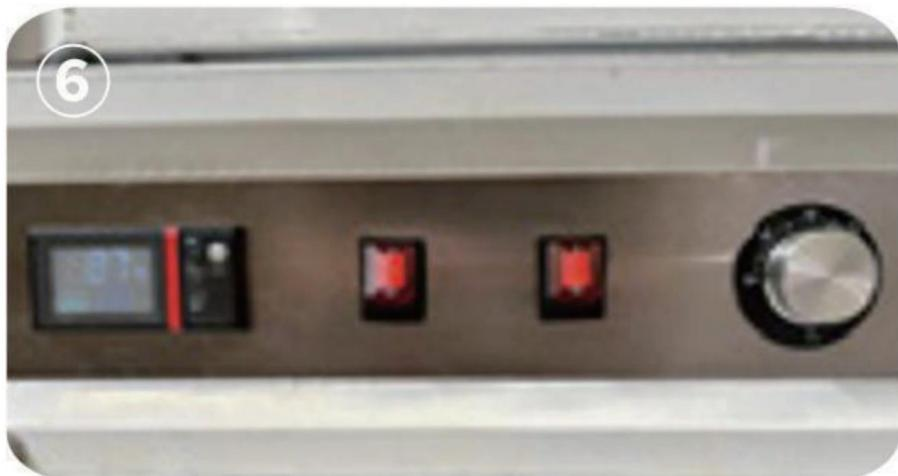
**Étape 7 : Réglage de la température de contrôle de la température principale Description de la fonction du panneau de commande du thermostat.**
