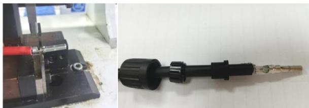
c. Método 1: Instale el cable en la ranura del terminal, colóquelo en la posición adecuada de la llave (como se muestra en la imagen), apriete y presione el cable para completar el remachado.
