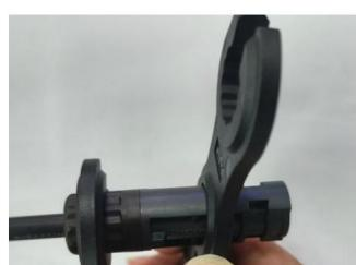
e. Placez le tampon étanche en séquence, verrouillez les dents et serrez l'écrou avec des outils pour terminer l'installation.
