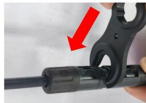
Paso 1: Suelte la hebilla del conector con una herramienta.
