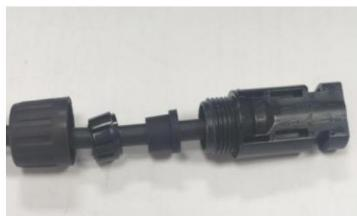
d. Druk de geklonken aansluiting in de connectorhuls en installeer deze op
