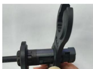
e. Umieść podkładkę wodoodporną w odpowiedniej kolejności, zablokuj zęby i dokręć nakrętkę za pomocą narzędzi, aby zakończyć instalację.
