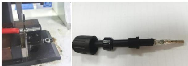
c. **Methode 1:** Setzen Sie den Draht in den Anschlusssschlitz ein, platzieren Sie ihn an der entsprechenden Stelle des Schraubenschlüssels (wie in der Abbildung gezeigt), drücken und pressen Sie den Draht, um das Nieten abzuschließen.
