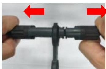
Stap 2: Trek de connector met de hand naar beide kanten en scheid de connector
