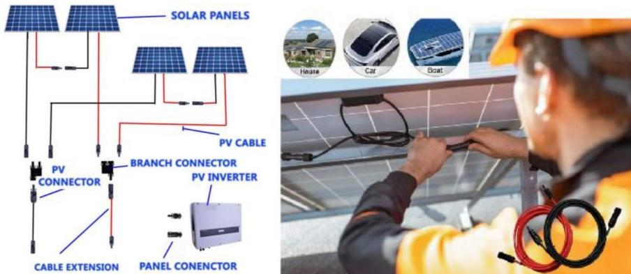
1. Zastosowanie: przewód przedłużający do paneli słonecznych jest elementem systemu fotowoltaicznego, zwykle posiadającym punkty dodatnie i ujemne. Jego główną rolą jest wydłużenie odległości połączenia kablowego między panelami słonecznymi, falownikami, ogniwami słonecznymi i innymi elementami w celu dostosowania do konkretnych potrzeb instalacyjnych i warunków na miejscu.
