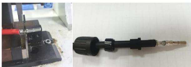
c. Metoda 1: Umieść przewód w szczelinie zacisku, umieść go w odpowiedniej pozycji klucza (jak pokazano na rysunku), ściśnij i dociśnij przewód, aby zakończyć nitowanie.
