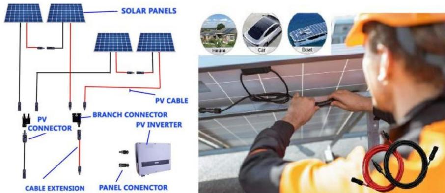
1. Utilizzo: il cavo di prolunga del pannello solare è un componente del sistema solare fotovoltaico, solitamente punti positivo e negativo, il suo ruolo principale è quello di estendere la distanza di collegamento del cavo tra pannelli solari, inverter, celle solari e altri componenti per adattarsi alle esigenze di installazione specifiche e alle condizioni del sito.
