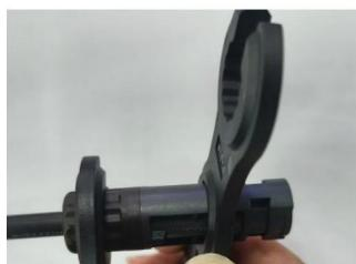
e. Posizionare il cuscinetto impermeabile in sequenza, bloccare i denti e serrare il dado con gli utensili per completare l'installazione.
