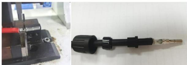
c. **Metod 1:** Installera tråden i terminalöppningen, placera den i lämplig position för skiftnyckeln (som visas på bilden), kläm och tryck på tråden för att slutföra nitning.
