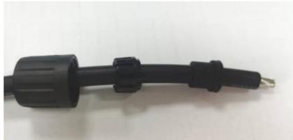
b. Coloque el cable uno a uno, ajuste la tapa, bloquee los dientes y pele el cable después de la almohadilla impermeable. La longitud de pelado es de 10 mm.
