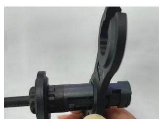
e. Plaats de waterdichte pad in de juiste volgorde, vergrendel de tanden en draai de moer vast met gereedschap om de installatie te voltooien.
