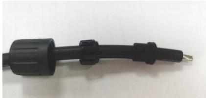
b. Włóż drut po kolej, dokręć nasadkę, zablokuj zęby i odklej drut po wodoodpornej podkładce. Długość odklejania wynosi 10 mm
