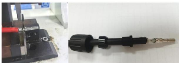
c. Méthode 1 : Installez le fil dans la fente du terminal, placez-le dans la position appropriée de la clé (comme indiqué sur l'image), pressez et appuyez sur le fil pour terminer le rivetage.
