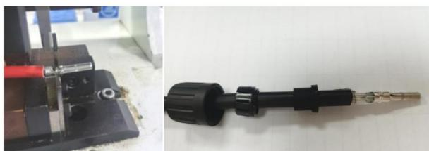
c. **Metodo 1:** installare il filo nella fessura del terminale, posizionarlo nella posizione appropriata della chiave (come mostrato nell'immagine), stringere e premere il filo per completare la rivettatura.
