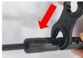
Schritt 1: Lösen Sie die Steckerschnalle mit einem Werkzeug
