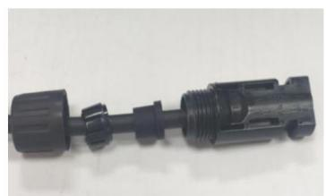
d. Premere il terminale rivettato nel manicotto del connettore e installarlo
