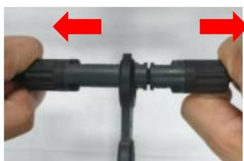
Schritt 2: Ziehen Sie den Stecker mit der Hand nach beiden Seiten und trennen Sie den Stecker
