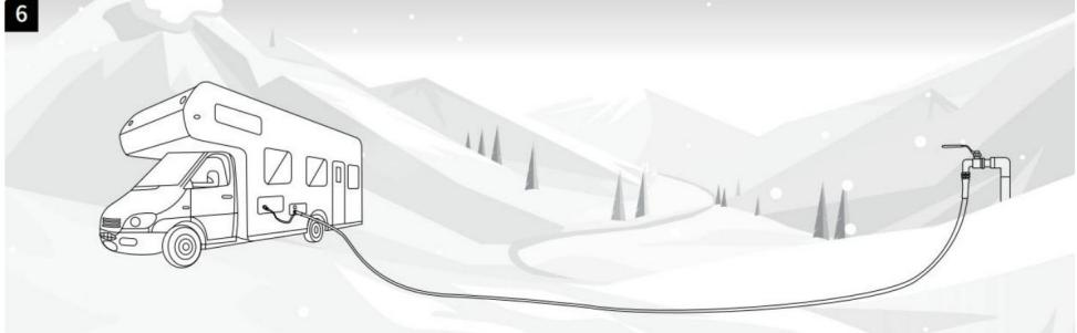
Po usunięciu wszystkich nieszczelności podłącz przewód zasilający do gniazdka elektrycznego (GFCI).
