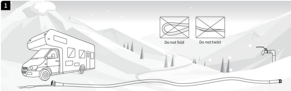
Confirmez ce qui sera connecté à chaque extrémité du tuyau et placez les deux extrémités au bon endroit en étendant complètement le tuyau sur le sol.
