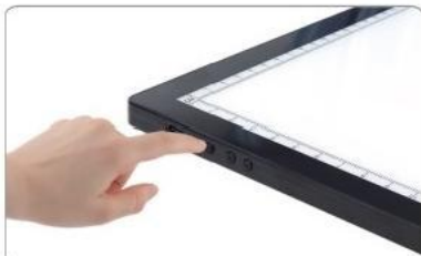
2. Po lekkim naciśnięciu przełącznika jasny pad start, aby zacząć działać. Naciśnij przycisk + aby dostosować odpowiednią jasność
