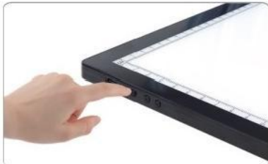
2. Efter att ha tryckt lätt på strömbrytaren ljus pad börjar att arbeta.TRYCK +-knappen för att justera den lämpliga ljusstyrka
