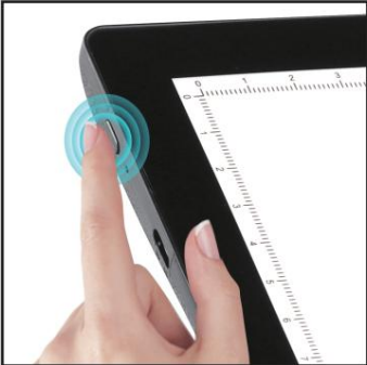
2. Dopo aver premuto leggermente il tasto di commutazione, la stazione di copia inizia a funzionare. Premere nuovamente il tasto per regolare la luminosità appropriata.
