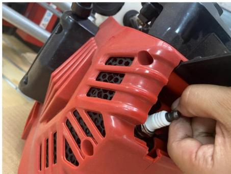
Vastdraaien met behulp van de sleutel zorg dragen niet te strak aandraaien.
