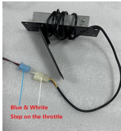
Rysunek 6 Okablowanie pedału/przyspieszenia
