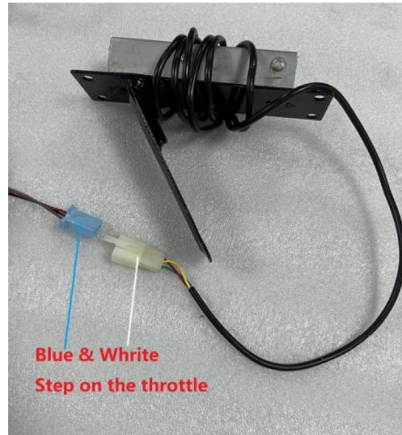
Figure 6 Le câblage de la pédale/accélérateur
