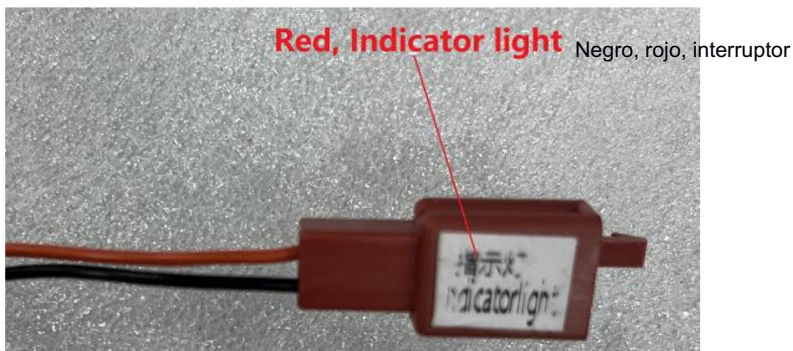
Figura 10 Cableado de luces indicadoras
