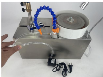
Il rubinetto è collegato alla pompa dell'acqua
