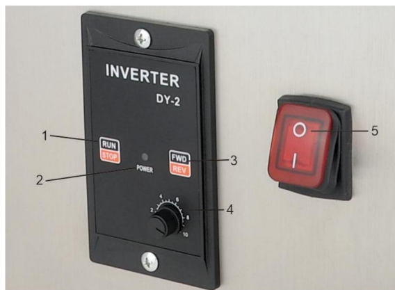
Controller 1. Pulsante Stop/Start. 2. Spia luminosa. 3. Ruotare in avanti e pulsanti indietro. 4. Manopola del potenziometro di regolazione della velocità velocità regolabile
