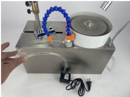
Der Wasserhahn ist mit der Wasserpumpe verbunden
