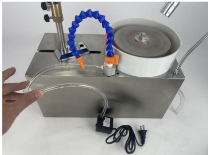
Le robinet est connecté à la pompe à eau
