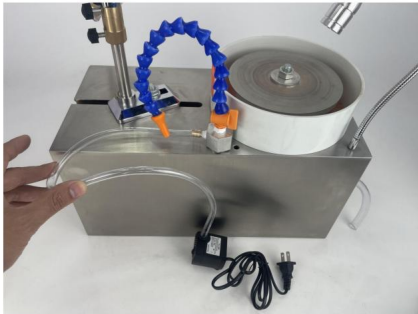
Kran jest podłączony do pompy wodnej
