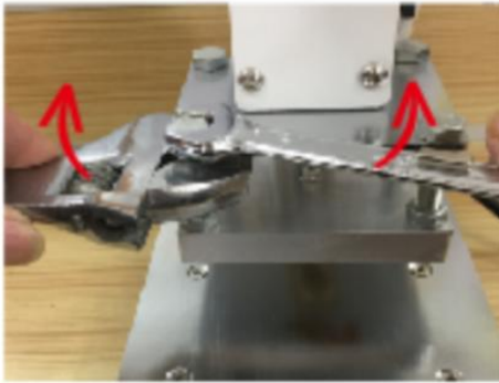
Réglage de l'équilibre de la plaque d'estampage à chaud : tout d'abord, desserrez les vis dans le sens inverse à l'aide d'une clé. Lorsque vous réglez la vis dans le sens des aiguilles d'une montre, la plaque d'estampage à chaud se déplace vers le haut ; dans le cas contraire, elle se déplace vers le bas
