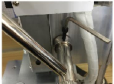
Slagkontroll fast ring: Använd den fasta strokekontrollringen för att justera
