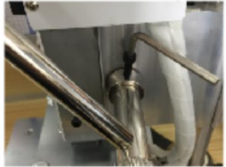
Bague fixe de contrôle de course : utilisez la bague de contrôle de course fixe pour régler la profondeur de l'estampage à chaud.
