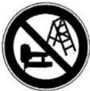
Fig. 4 : Symbole « Ne pas utiliser sur des échafaudages, des échelles »
