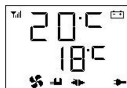
État de mise sous tension (mode automatique)
