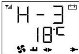
État de mise sous tension (mode manuel)
