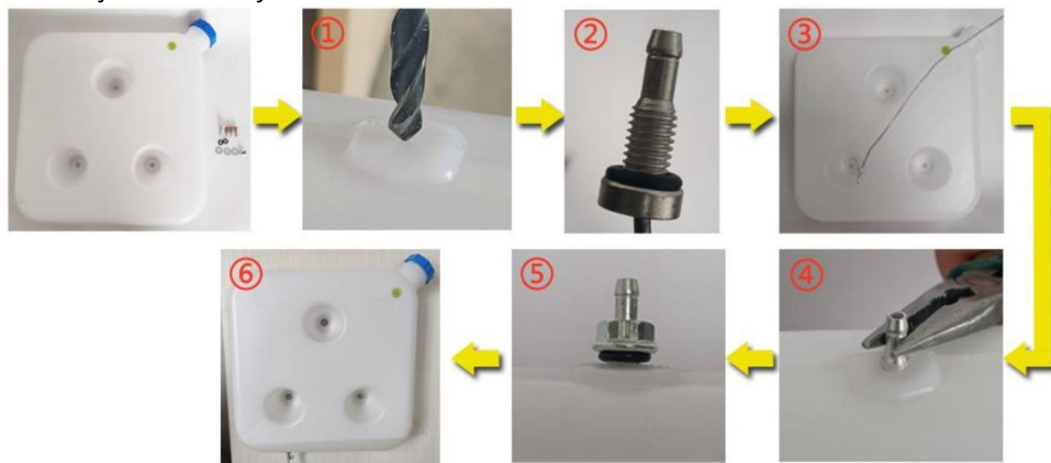
Schemat instalacji zbiornika paliwa
