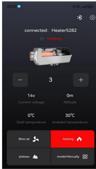
Estado de encendido (modo manual)
