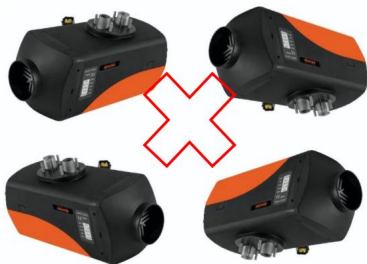
Direzione di installazione errata
