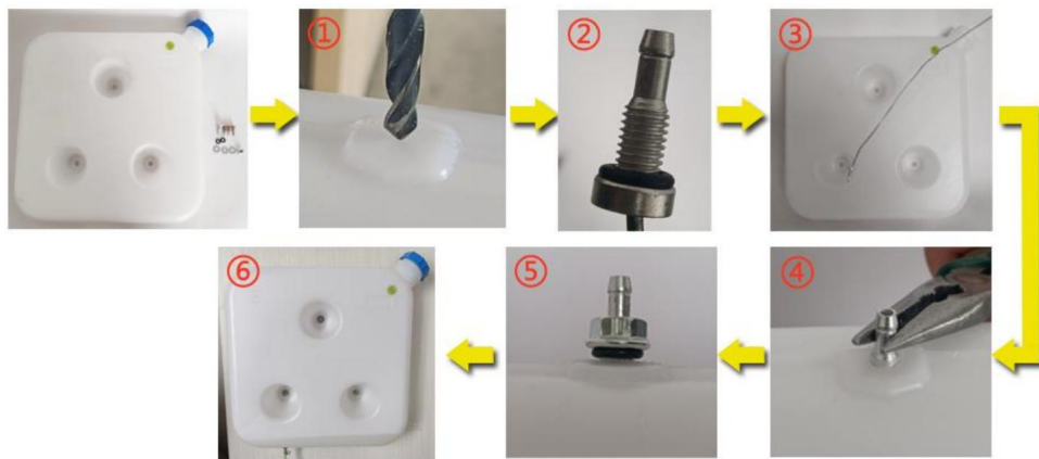
Schema di installazione del serbatoio del carburante
