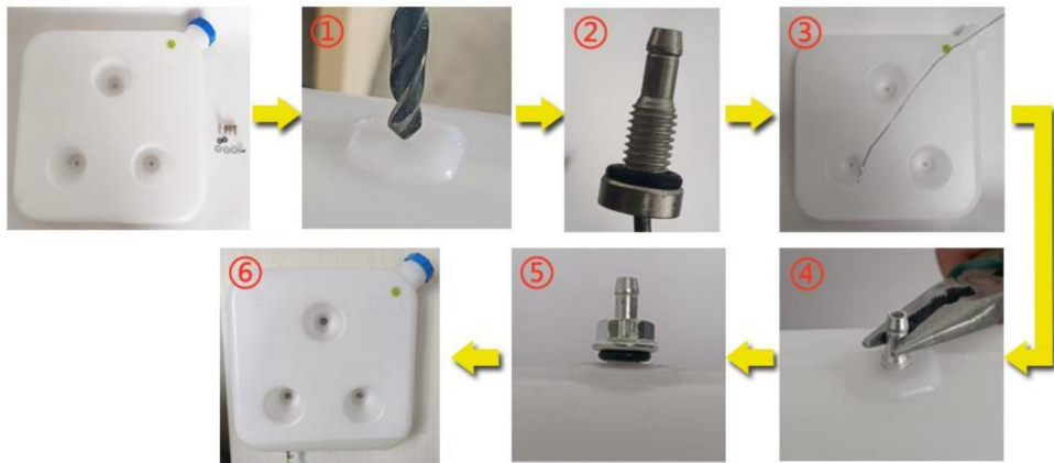
Schemat instalacji zbiornika paliwa
