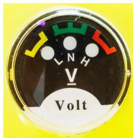
Descripción de la luz indicadora: Luz amarilla "L": La energía de la batería es baja, necesita cargarse.
