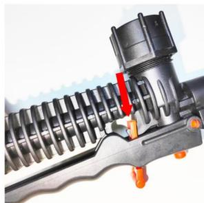
2. Quando si spruzza per un lungo periodo, la maniglia può essere fissata tramite l'anello.
