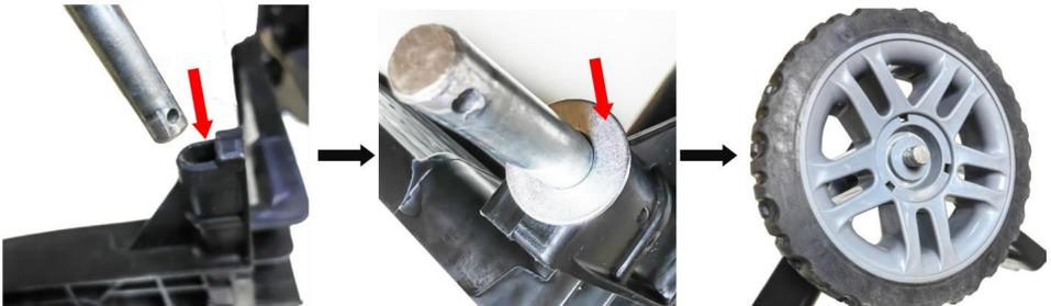
3. Setzen Sie die zweite Stahl dichtung in die Stange ein, stecken Sie dann den Splint in das Loch der Stange und biegen Sie anschließend die Unterseite des Splints mit einer Spitzzange.
