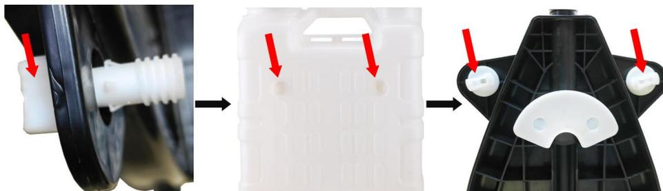
09. WYJMIOWANIE SPRYSKIWACZA Z WÓZKA 1. Odkręć plastikową śrubę, a następnie wyjmij spluwacz.
