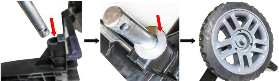
3. Inserte la segunda junta de acero en la varilla, luego inserte la chaveta dividida en el orificio de la varilla y luego doble la parte inferior de la chaveta dividida con unos alicates de punta afilada.
