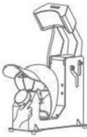
3. La placa calefactora se presiona automáticamente hacia abajo después de presionar el botón.
