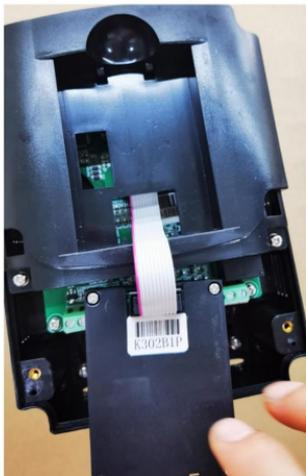
Sposób instalacji klawiatury z przewodem łączącym Krok
