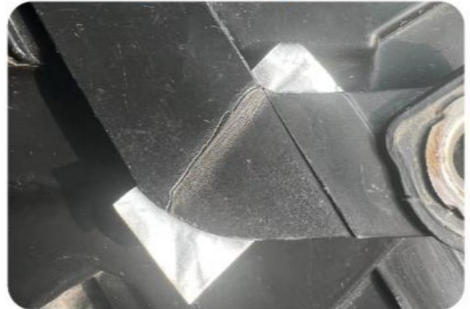
2. Stick fast den trasiga delen med metallfolie för enkelt underhåll
