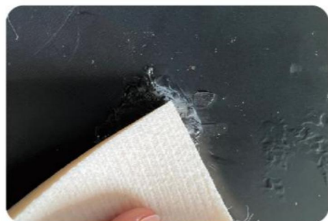
3. Utilizzare la testina lisciante calda per fondere la maglia di acciaio inossidabile nota la plastica di base
