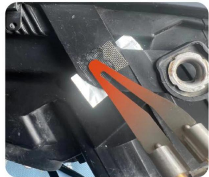
4. Utilizzare la testa di levigatura a caldo per sciogliere la plastica di base
