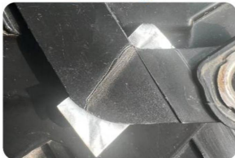
2. Pegue la parte rota con papel de aluminio para facilitar el mantenimiento.
