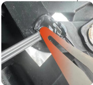
5. Faire fondre la baguette de soudure pour couvrir tout le filet de réparation
