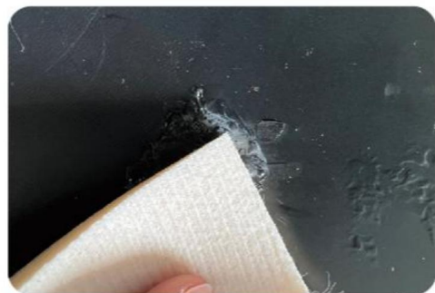
3. Utilisez la tête de lissage chaude pour faire fondre la maille en acier inoxydable dans la base en plastique
