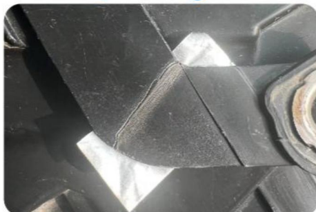
2. Plak het gebroken deel vast met metaalfolie voor eenvoudig onderhoud
