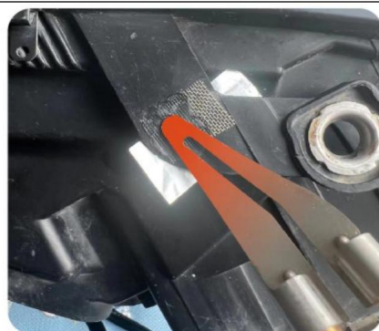
4. Gebruik de hete gladmaakkop om de plastic basislaag te smelten
