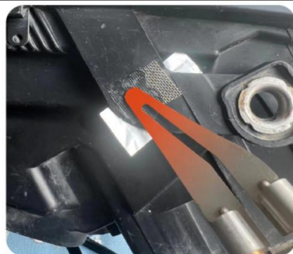
4. Utilice el cabezal alisador caliente para derretir la parte plástica base.
