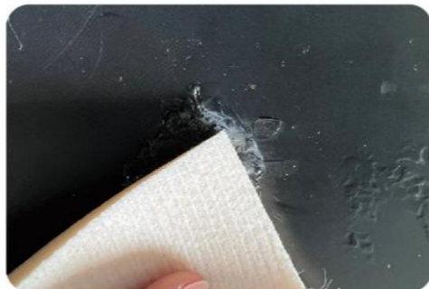
3. Använd det varma utjämningshuvudet för att smält rostfritt stål mesh into the basplast
