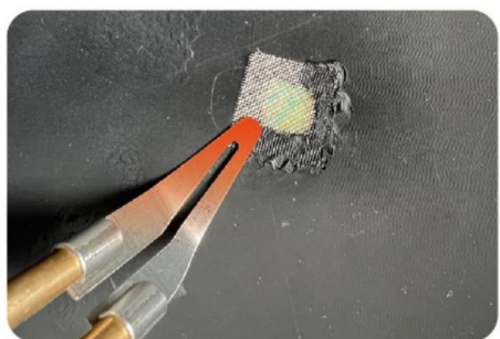
3. Utilizzare la testina lisciante calda per fondere la maglia di acciaio inossidabile nota la plastica di base
