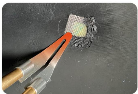
3. Utilisez la tête de lissage chaude pour faire fondre la maille en acier inoxydable dans la base en plastique
