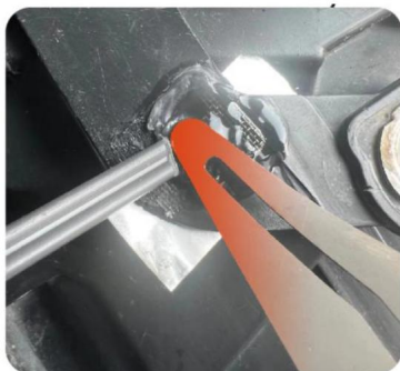
5. Smelt de lasstaaf om het hele reparatienet te bedekken
