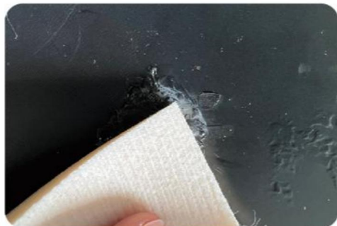
3. Gebruik de hete gladmaakkop om smelt roestvrij stalen gaas noto de basis kunststof
