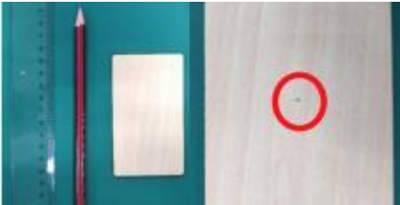
image 1 dessiner un centre indiquer sur l'objet gravé
