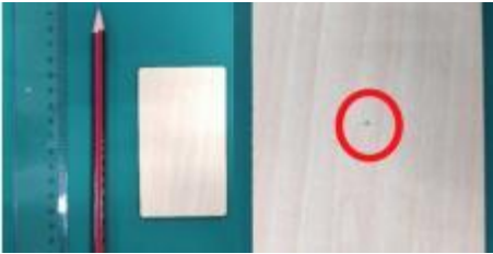
afbeelding 1 teken een centrum punt op het gegraveerde object
