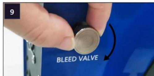
Drehen Sie die Nadel der automatischen Abschaltung manuell
