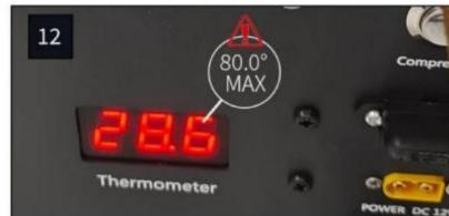
Während des Ladevorgangs wird die Temperatur des Geräts (in Grad Celsius) auf dem LCD-Display oben auf dem Hauptgerät angezeigt [Abb. 12]. Diese sollte während des gesamten Ladevorgangs überwacht werden.
