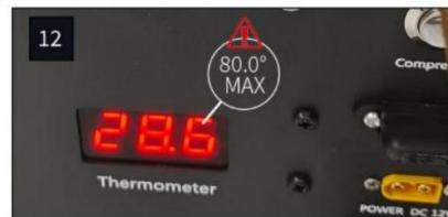
Under laddningsprocessen kommer enhetens temperatur (i grader Celsius) att synas i LCD-displayen på toppen av huvudenheten [fig 12]. Detta bör övervakas under hela laddningsprocessen.
