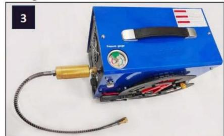
Slangenheten fästs till PCP-luftpistolen i andra änden via en Foster-fit.
