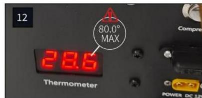
Durante il processo di carica, la temperatura dell'unità (in gradi Celsius) sarà visibile sul display LCD nella parte superiore dell'unità principale [fig 12]. Questa deve essere monitorata durante tutto il processo di carica.
