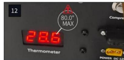
Podczas ładowania na wyświetlaczu LCD znajdującym się na górze jednostki głównej będzie widoczna temperatura urządzenia (w stopniach Celsjusza) [rys. 12]. Należy ją monitorować przez cały czas ładowania.
