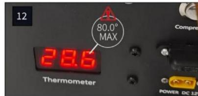
Tijdens het opladen wordt de temperatuur van het apparaat (in graden Celsius) weergegeven op het LCD-scherm aan de bovenkant van het hoofdapparaat [fig. 12]. Dit moet tijdens het hele oplaadproces in de gaten worden gehouden.
