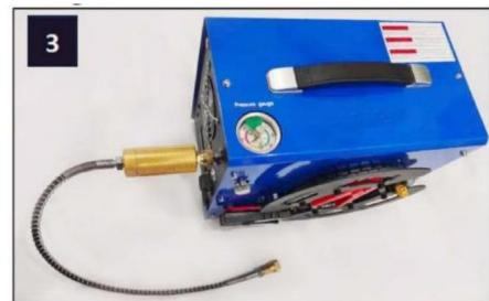
Il gruppo tubo flessibile si collega alla pistola ad aria compressa PCP all'altra estremità tramite un raccordo Foster.
