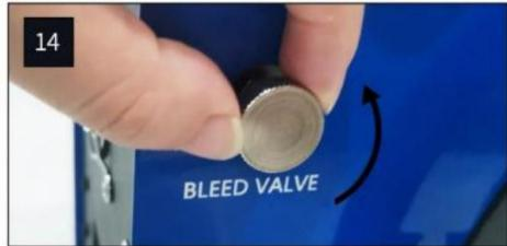
Efter blödning av, hela slang/Dri-Pak™ montering kan tas bort från PCP luftgevär och, om krävs, det huvudsakliga kompressorenhet genom att låsa upp Foster-kontakterna (se sida 5).
