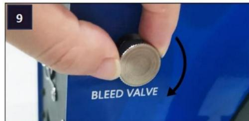
Ruotare manualmente l'ago dello spegnimento automatico
