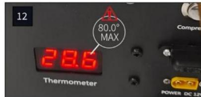
Durante el proceso de carga, la temperatura de la unidad (en grados Celsius) será visible en la pantalla LCD en la parte superior de la unidad principal [fig 12]. Esto debe controlarse durante todo el proceso de carga.
