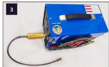
De slang wordt aan het andere uiteinde met een Foster-fitting aan het PCP-luchtgeweer bevestigd. Een extra adapter/connector kan nodig zijn [fig. 4] vanwege de vele verschillende soorten vulfittingen die worden gebruikt bij PCP-luchtgeweren (raadpleeg de specifieke PCP-fabrikant). Let op: een schroefdraad-naar-Foster-adapter is inbegrepen in het accessoirepakket [fig. 5].
