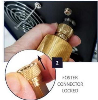
Die Schlauchbaugruppe wird am anderen Ende über eine Foster-Fit-Verbindung an der PCP-Luftpistole befestigt. Aufgrund der vielen verschiedenen Füllanschlüsse, die bei verschiedenen PCP-Luftgewehrmarken verwendet werden, kann ein zusätzlicher Adapter/Anschluss erforderlich sein [Abb. 4] (siehe spezifischer PCP-Hersteller). Hinweis: Ein Gewinde-zu-Foster-Adapter ist im Zubehörpaket enthalten [Abb. 5].
