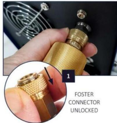
Nota: controllare sempre che la connessione sia ben fissata.
