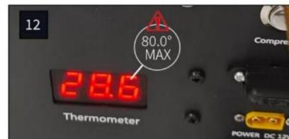
Pendant le processus de charge, la température de l'appareil (en degrés Celsius) sera visible sur l'écran LCD situé sur le dessus de l'unité principale [fig 12]. Elle doit être surveillée tout au long du processus de charge.
