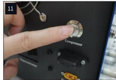
Selon la taille du cylindre d'air du pistolet à air PCP, son état de charge et la pression cible, le temps de charge varie. En général, il faut environ 25 minutes pour charger un cylindre vide d'une capacité de 500 cc à
