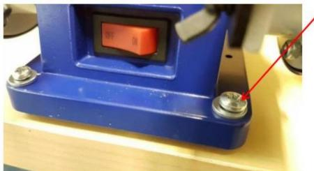
Befestigen Sie die Schleifmaschine an einer Werkbank.
