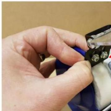
Coloque los dos protectores oculares utilizando el tornillos pequeños, arandelas y tornillos de seguridad Arandelas.
