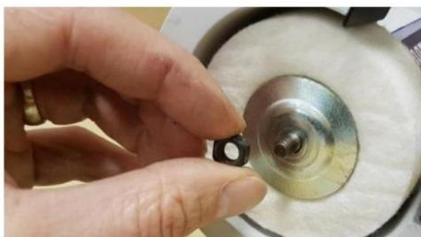
Deslice con cuidado el trapeador sobre el eje, vuelva a colocar la brida de la placa, la tuerca y
