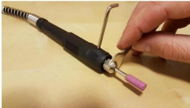
Para colocar una herramienta en el eje flexible:
