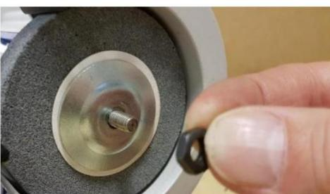
Inspectez la nouvelle pierre pour détecter les fissures et dommages à la face avant ou à la bords avant le montage.
