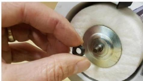
Faites glisser soigneusement la serpillière sur l'arbre, remettez la bride de la plaque, l'écrou et serrer contre la rotation de la serpillière.
