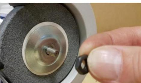
Sprawdź nowy kamień pod kątem pęknięć i uszkodzenie przedniej powierzchni lub krawędzie przed dopasowaniem.
