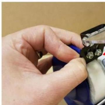
Za pomocą dwóch osłon oczu zamocuj małe śruby, podkładki i blokada podkładki.
