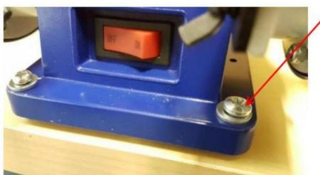
Fixez le broyeur sur un banc.
