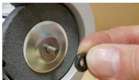
Untersuchen Sie den neuen Stein auf Risse und Beschädigung der Vorderseite oder der Kanten vor dem Einbau.
