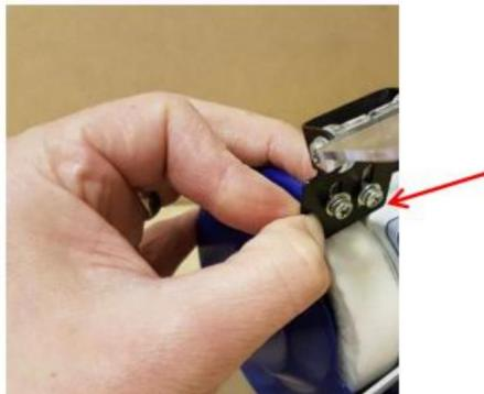
Befestigen Sie die beiden Augenmuscheln mit den kleinen Schrauben, Unterlegscheiben und Sicherungsringen Unterlegscheiben.
