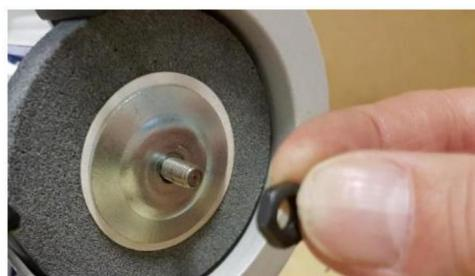
Inspeccione la piedra nueva para ver si tiene grietas y daños en la cara frontal o en la bordes antes del montaje.
