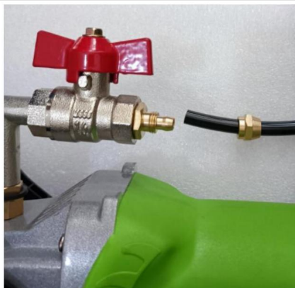
3. Installeer waterleidingverbindingen, vergrendel ze met een sleutel.
