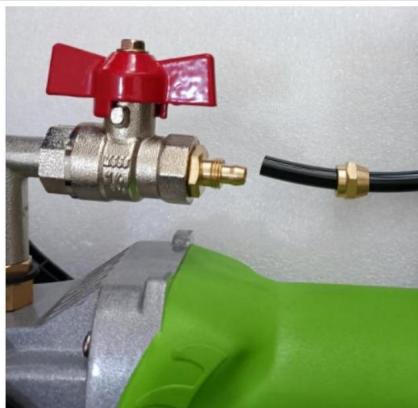
3. Instale las juntas de las tuberías de agua y fíjelas con una llave.
