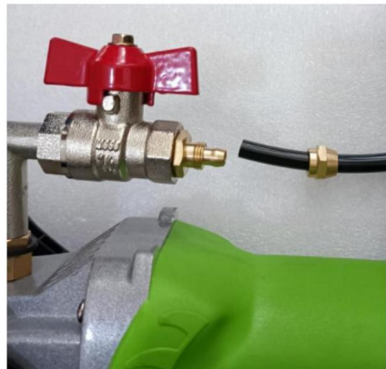
3. Wasserrohrverbindungen installieren und mit einem Schraubenschlüssel festziehen.
