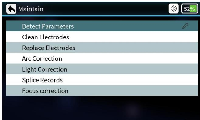
③ Plaats de vezels en sluit de klep, de zelftest zal aan staan. Normaal gesproken duurt de test 2 minuten. Let op de melding op het LCD-scherm, als de test mislukt, voer dan de instructies op het scherm uit en schakel de systeemdetectie opnieuw in (stap ①).
