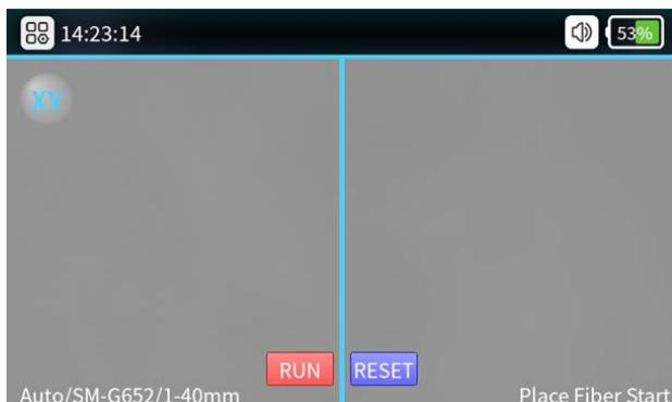
Interfaz de observación de fibra óptica: Presione brevemente el interruptor de encendido, luego el indicador en el panel de operación se pondrá rojo y el timbre sonará como "Di Di ". Todos los motores volverán a sus posiciones iniciales y la interfaz de observación de fibra mostrará .
