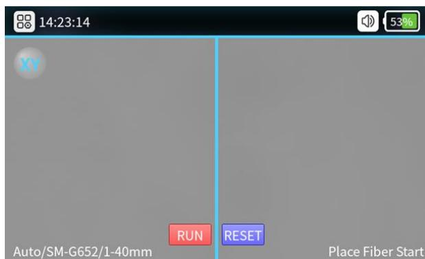
Glasfaser-Beobachtungsschnittstelle: Drücken Sie kurz den Netzschalter, dann leuchtet die Anzeige auf dem Bedienfeld rot und der Summer ertönt „Di Di“. Alle Motoren kehren in ihre Ausgangsposition zurück und die Glasfaser-Beobachtungsschnittstelle zeigt an .
