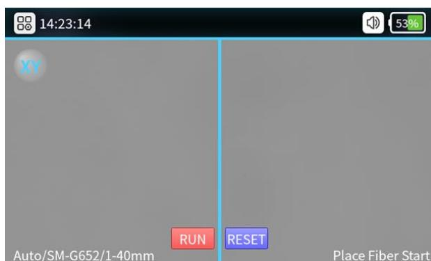
Interface d'observation de la fibre optique : appuyez brièvement sur l'interrupteur d'alimentation, puis l'indicateur du panneau de commande devient rouge et le buzzer émet un son semblable à « Di Di ». Tous les moteurs reviennent à leur position initiale et l'interface d'observation de la fibre affiche .
