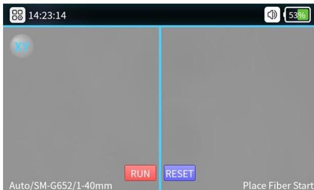
Interface voor optische vezelobservatie: druk kort op de aan/uit-schakelaar, dan wordt de indicator op het bedieningspaneel rood en klinkt de zoemer zoals "Di Di ". Alle motoren keren terug naar hun beginposities en de interface voor optische vezelobservatie toont .
