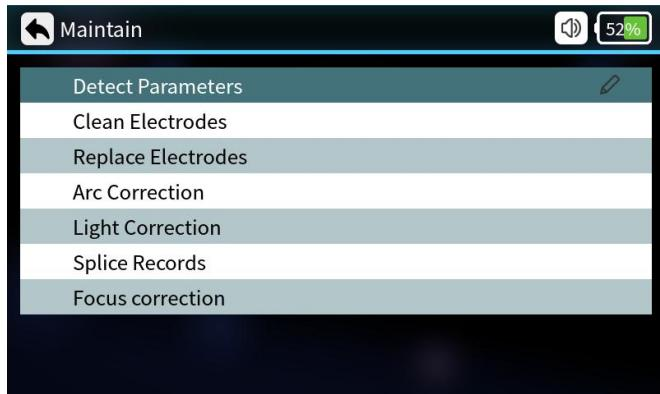
③ Setzen Sie die Fasern ein und schließen Sie die Abdeckung. Der Selbsttest wird gestartet. Normalerweise dauert der Test 2 Minuten. Bitte beachten Sie die Meldung auf dem LCD-Bildschirm. Wenn der Test fehlschlägt, befolgen Sie die Anweisungen auf dem Bildschirm und aktivieren Sie die Systemerkennung erneut (Schritt ①).
