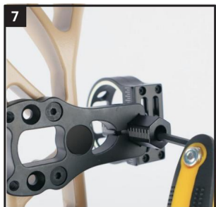
Jak na zdjęciu 7, śruba umożliwia regulację podpórki strzałki w lewo/prawo
