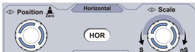
Figure 3- 11 Zone de contrôle horizontale
