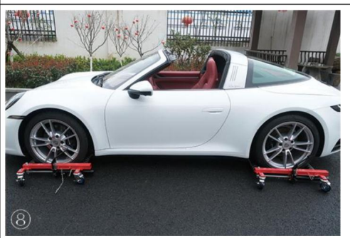
8. Aby zwolnić wózek z kółkami, pociągnij za sworzeń poza ramę i otwórz wartość, obracając pokrętko w kierunku przeciwnym do ruchu wskazówek zegara.
