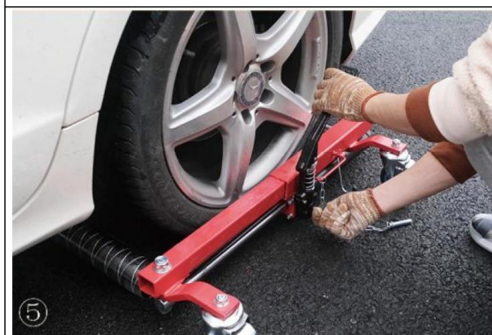
5. Zamknąć wartość zwolnienia, obracając pokrętko
