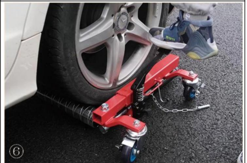
6. Placez le pied sur la pédale en appuyant doucement pour soulever le pneu de la surface d'un pouce ou moins.
