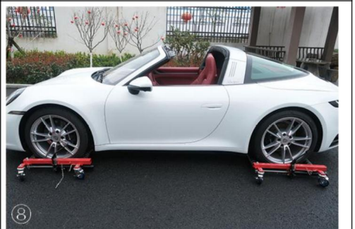
8. Pour libérer les chariots à roues, tirez sur la goupille hors du cadre et ouvrez la valeur en tournant volant dans le sens inverse des aiguilles d'une montre.
