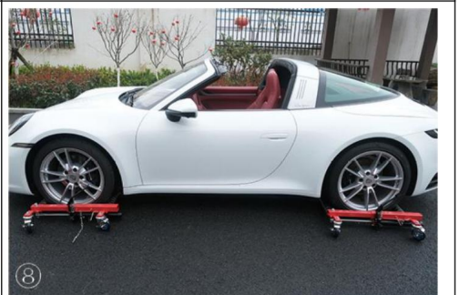
8. Um die Radwagen zu lösen, ziehen Sie den Stift aus dem Rahmen zu nehmen und durch Drehen den Wert öffnen Handrad gegen den Uhrzeigersinn drehen.
