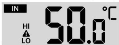
Alarm wysoki / niski włączony
