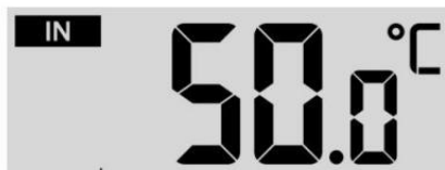
Alarme haute / basse désactivé
