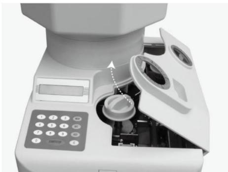
Luego, levante el brazo de la polea de alimentación frontal y empuje y tire de la placa de bloqueo hacia arriba para quitar los objetos extraños.
