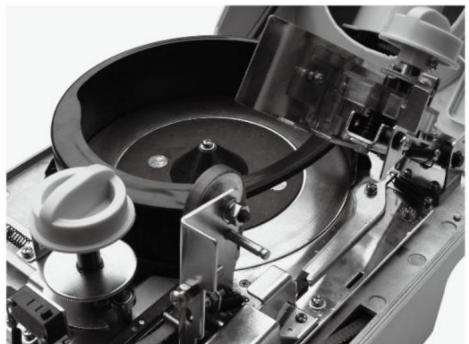
L'écran LCD affiche « EJ » : allumez la machine. Si le capteur de comptage est recouvert de poussière, l'écran LCD affichera « EJ ». Veuillez retirer la courroie trapézoïdale, nettoyez le capteur de comptage à l'aide d'un coton-tige imbibé d'alcool dénaturé.
