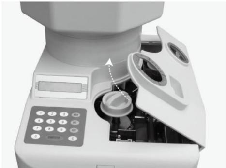
ÿ Ziehen Sie dann den vorderen Vorschubrollenarm nach oben und drücken und ziehen Sie die Verriegelungsplatte nach oben, um die Fremdkörper zu entfernen.
