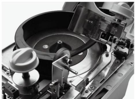
**LCD-displayen "EJ":** Slå på maskinen. Om räknesensorn är täckt av damm kommer LCD-skärmen att visa "EJ", ta bort kilremmen, rengör räknesensorn med en bomullspinne med denaturerad alkohol.
