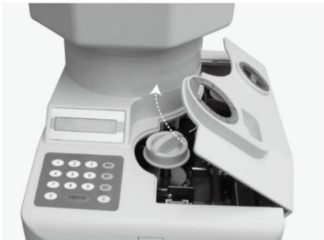
Następnie podnieś ramię przedniego koła pasowego podającego i pchnij i pociągnij płytę blokującą w górę, aby usunąć ciała obce.
