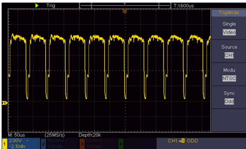
Abbildung 6- 7 Vom Video Field Trigger erfasste Wellenform
