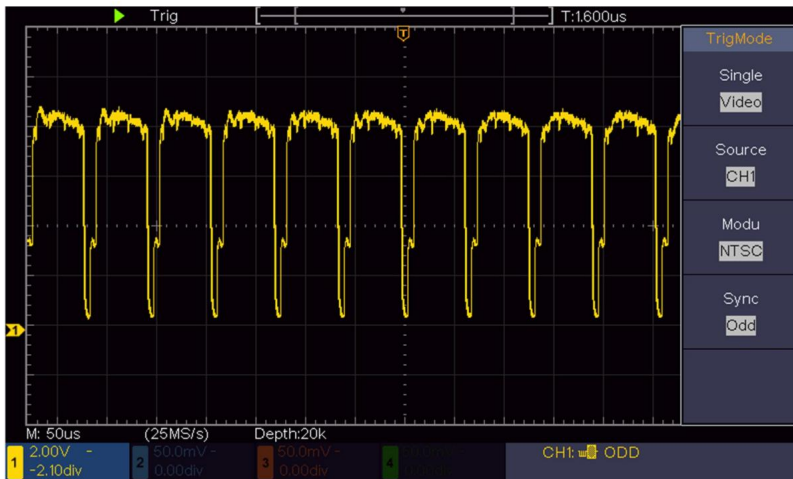
Figura 6-7 Forma d'onda catturata dal trigger del campo video
