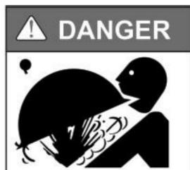
**Der hohe Druck des Sandfilters kann zu schweren Verletzungen oder schweren Sachschaden durch Tanktrennung.**
