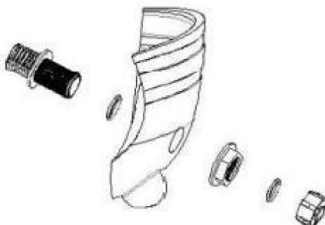
4. Plaats de filtertank op de systeembasis en draai hem een beetje met de klok mee bit. Plaats de filtertank zo dat de winterafvoer in de tegenovergestelde richting van de de pomp.
