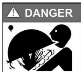
**L'alta pressione del filtro a sabbia può causare gravi lesioni o gravi danni materiali dovuti alla separazione del serbatoio.**
