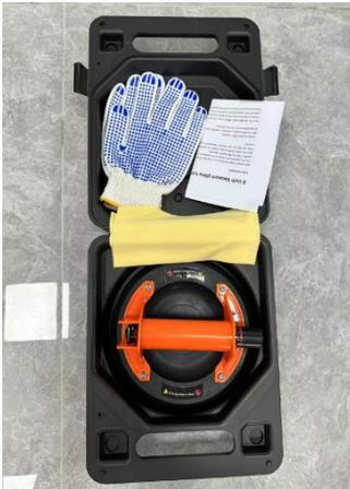
1. Öffnen Sie die Kunststoffbox mit dem Vakuumsauger und prüfen Sie, ob Produkt und Zubehör intakt sind.
