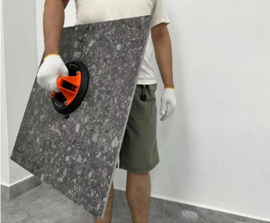
4. Efter fullständig uppblåsning, kontrollera den röda varningslinjen för att se om den har dragits tillbaka. Om den inte har dragits tillbaka kan objektet flyttas.
