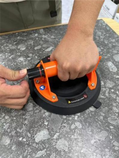
3. Plaats de vacuümzuignap tijdens het gebruik plat op het oppervlak van het te adsorberen object; druk de vacuümzuignap lichtjes aan met uw hand om volledig contact te verzekeren tussen de rubberen pad en het oppervlak van het object. Druk vervolgens op de opblaasknop totdat deze volledig is opgeblazen en de rode waarschuwingslijn niet meer zichtbaar is.
