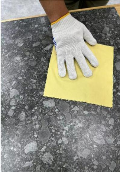
2. Reinig tijdens het gebruik het oppervlak van het te adsorberen object met een antistatische doek om een glad oppervlak te garanderen.
