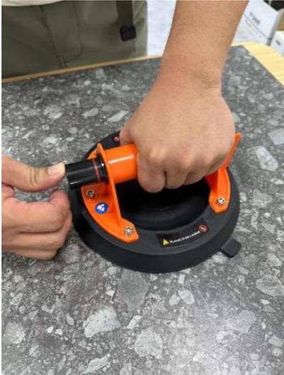
3. Legen Sie den Vakuumsauger während des Betriebs flach auf die Oberfläche des zu adsorbierenden Objekts. Drücken Sie den Vakuumsauger leicht mit der Hand, um einen vollständigen Kontakt zwischen dem Gummipolster und der Oberfläche des Objekts sicherzustellen. Drücken Sie dann den Aufblasknopf, bis er vollständig aufgeblasen ist und die rote Warnlinie nicht mehr sichtbar ist.
