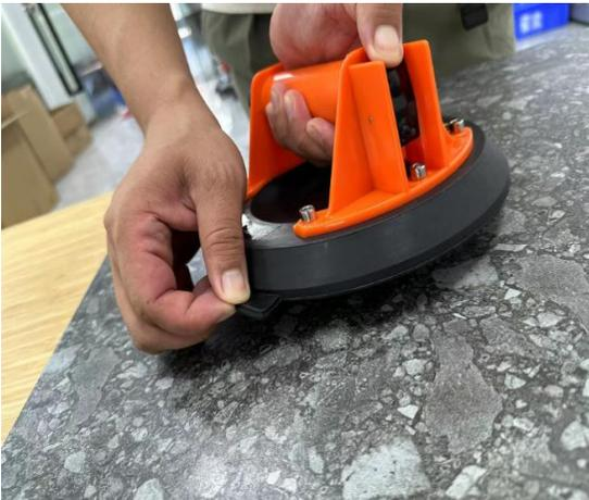
5. Nadat het transportproces is voltooid, tilt u voorzichtig de leeglooptong op of drukt u op de zwarte leegloopknop om de zuignap te verwijderen.
