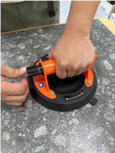
3. Lors du fonctionnement, placez la ventouse à vide à plat sur la surface de l'objet à adsorber ; appuyez légèrement sur la ventouse à vide avec votre main pour assurer un contact complet entre le tampon en caoutchouc et la surface de l'objet. Appuyez ensuite sur le bouton de gonflage jusqu'à ce qu'il soit complètement gonflé et que la ligne d'avertissement rouge ne soit plus visible.
