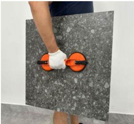
4. Nachdem Sie den Gegenstand bewegt haben, ziehen Sie den Griff zurück in seine ursprüngliche Position, damit der Saugnapf wieder flach wird und der Vakuumdruck nachlässt. Damit ist ein Hebevorgang abgeschlossen. Wenn der Saugnapf am Gegenstand befestigt bleibt und sich nicht entfernen lässt, können Sie die Kante des Saugnapfs mit Ihrem Finger leicht anheben, damit Luft in den Vakuumhohlraum gelangt und die beiden Teile getrennt werden.
