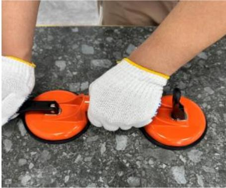
3. Umieść przyssawkę płasko na przedmiocie i mocno dociśnij do powierzchni przedmiotu, jednocześnie pociągając w dół plastikowy uchwyt. Przyssawka zostanie podniesiona i odkształcona, tworząc wnękę ze znaczną próżnią między przyssawką a przedmiotem. Ciśnienie atmosferyczne powoduje, że przyssawka mocno trzyma przedmiot. W tym momencie przedmiot można podnieść i przenieść ręcznie.
