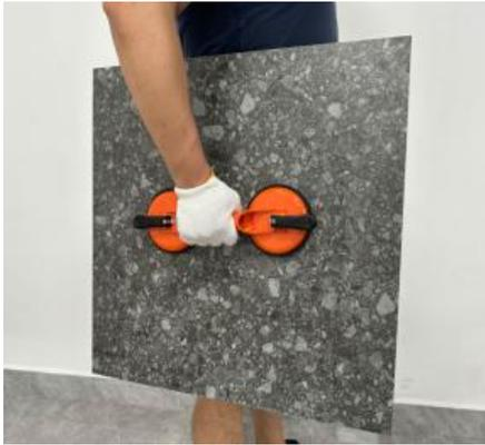
4. Efter att ha flyttat föremålet, dra tillbaka handtaget till sitt ursprungliga läge, så att sugkudden kan återgå till sitt plana tillstånd och släppa vakuumtrycket, vilket slutför en lyftoperation. Om sugkoppen förblir fäst vid föremålet och inte kan tas bort, kan du lyfta kanten på sugkudden lätt med fingret för att släppa in luft i vakuumhålet och separera de två.
