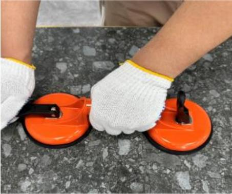
3. Plaats de zuignap plat tegen het item en druk stevig op het oppervlak van het item terwijl u tegelijkertijd de plastic handgreep naar beneden trekt. De zuignap wordt opgetild en vervormd, waardoor er een holte ontstaat met een aanzienlijk vacuüm tussen de zuignap en het item. De atmosferische druk zorgt ervoor dat de zuignap het item stevig vasthoudt. Op dit punt kan het item met de hand worden opgetild en verplaatst.
