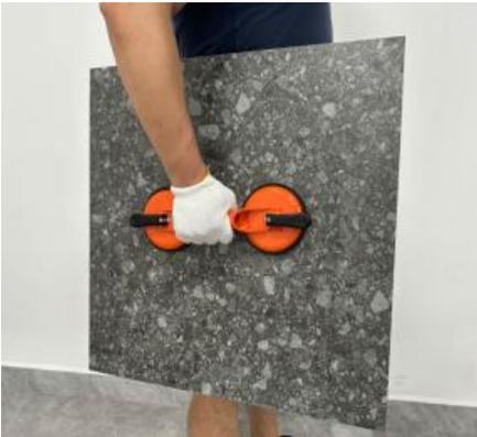
4. Nadat u het item verplaatst, trekt u de hendel terug naar de oorspronkelijke positie, zodat de zuignap weer plat wordt en de vacuümdruk wordt vrijgegeven, waarmee u één hefhandeling voltooit. Als de zuignap aan het item blijft zitten en niet kan worden verwijderd, kunt u de rand van de zuignap met uw vinger iets optillen om lucht in de vacuümholte te laten en de twee te scheiden.
