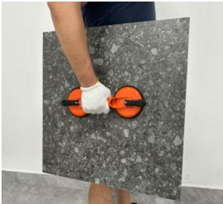
4. Après avoir déplacé l'objet, ramenez la poignée à sa position initiale, ce qui permet à la ventouse de revenir à son état plat et de relâcher la pression du vide, ce qui permet de terminer une opération de levage. Si la ventouse reste attachée à l'objet et ne peut pas être retirée, vous pouvez soulever légèrement le bord de la ventouse avec votre doigt pour laisser entrer l'air dans la cavité du vide et séparer les deux.
