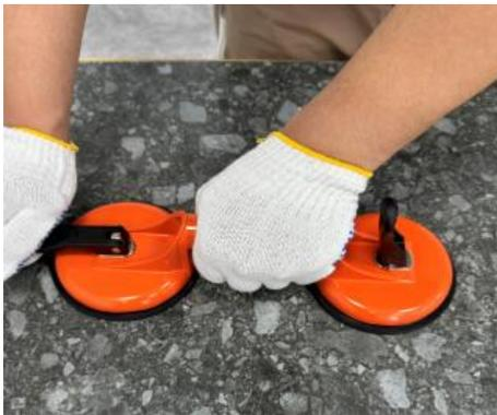
3 . Placera sugkudden plant mot föremålet och tryck ordentligt på föremålets yta samtidigt som du drar ner plasthandtaget. Sugdynan kommer att lyftas och deformerar, vilket skapar ett hålrum med ett avsevärt vakuum mellan sugdynan och föremålet. Atmosfärstrycket gör att sugkoppen håller föremålet stadigt. Vid denna tidpunkt kan föremålet lyftas och flyttas för hand.
