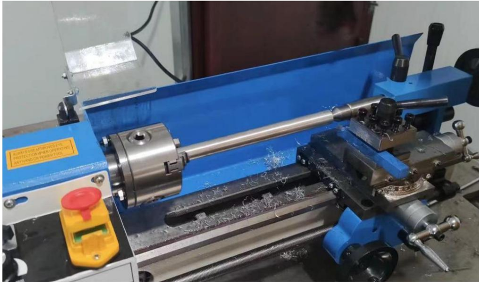
Abb. 6 Werkstück halten und bohren
