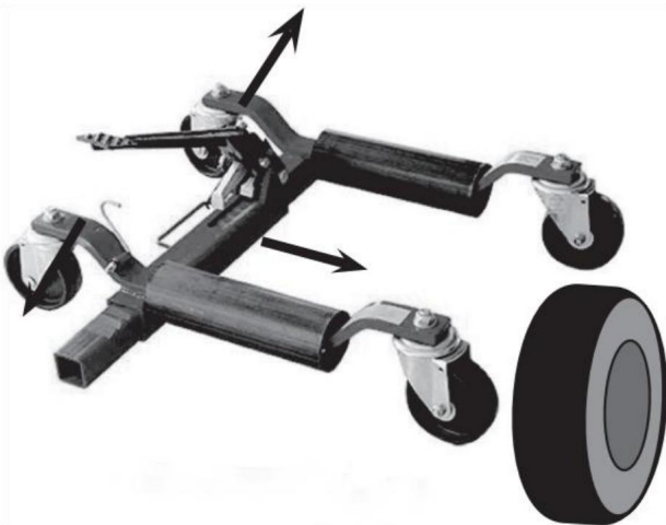
Posizionamento del carrello attorno al pneumatico (leva in posizione sollevata)
