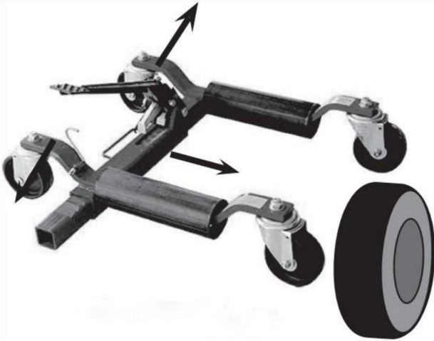
Colocación del carro alrededor del neumático (palanca en posición elevada)
