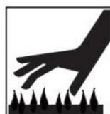
**Heta delar.** Föremål som svetsas/kapas genererar och håller hög värme och kan orsaka allvarliga brännskador.
