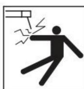
**Elektrisk stöt: Det kan döda.** Beröring av strömförande elektriska delar kan orsaka dödliga stötar eller allvarliga brännskador. Elektroden och arbete kretsen är strömförande när utgången är på. Ingången strömkretsar och interna maskinkretsars är också strömförande när strömmen är på. Vid MIG/MAG-svetsning, tråden, drivrullar, trådmatarhuset, och alla metalldelar som berör svetstråden är strömförande.
