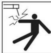
**Elektrische schok: Het kan dodelijk zijn.** Het aanraken van onder spanning staande elektrische onderdelen kan dodelijke schokken of ernstige brandwonden veroorzaken. De elektrode en het werk circuit staat elektrisch onder spanning wanneer de uitgang aan staat. De ingang stroomcircuits en interne machinecircuits staan ook onder spanning wanneer stroom is ingeschakeld. Bij MIG/MAG-lassen zijn de draad, aandrijfrollen, draad
