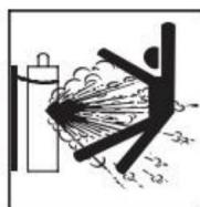
Bouteilles de gaz. Les bouteilles de gaz de protection contiennent du gaz sous haute pression. Si elle est endommagée, une bouteille peut exploser. Parce que le gaz les cylindres font normalement partie du processus de soudage/coupe, assurez-vous de les traiter avec soin. Les CYLINDRES peuvent exploser si endommagé.
