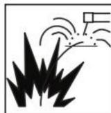
**Brandgefahr.** Schweißen/Schneiden an geschlossenen Behältern, wie Tanks, Fässer oder Rohre können explodieren. Funkenflug vom Schweiß-/Schneidlichtbogen, heißen Werkstücken und heißen Geräten kann Brände und Verbrennungen verursachen. Ein versehentlicher Kontakt der Elektrode mit Metallgegenstände können Funken, Explosionen, Überhitzung oder Feuer verursachen.
