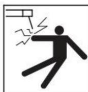
Choc électrique : il peut être mortel. Le contact avec des pièces électriques sous tension peut provoquer des chocs mortels ou des brûlures graves. L'électrode et le travail le circuit est électriquement sous tension lorsque la sortie est activée. L'entrée le circuit d'alimentation et les circuits internes de la machine sont également sous tension lorsque l'alimentation est sous tension. En soudage MIG/MAG, le fil, les galets d'entraînement, le fil
