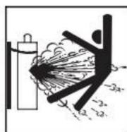
**Bombole di gas.** Le bombole di gas di protezione contengono gas ad alta pressione. Se danneggiato, un cilindro può esplodere. Poiché il gas i cilindri sono normalmente parte del processo di saldatura/taglio, assicurarsi di trattarli con cura. I CILINDRI possono esplodere se danneggiato.
