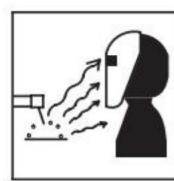
Rayos de arco: dañinos para los ojos y la piel de las personas. Los rayos de arco de la El proceso de soldadura/corte produce imágenes intensas, visibles e invisibles. rayos ultravioleta e infrarrojos que pueden quemar los ojos y la piel. Siempre Use un casco de soldadura con un filtro de tono correcto y ropa protectora adecuada, incluidos guantes de soldador, mientras
