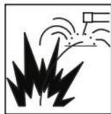
**Brandgevaar.** Lassen/snijden van gesloten containers, zoals tanks, vaten of pijpen, kunnen ervoor zorgen dat ze ontploffen. Rondvliegende vonken van de las-/snijboog, het hete werkstuk en hete apparatuur kan branden en brandwonden veroorzaken. Onbedoeld contact van elektrode met Metalen voorwerpen kunnen vonken, explosies, oververhitting of brand veroorzaken.
