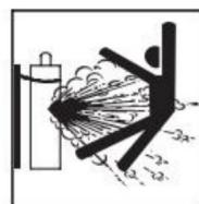
**Gascilinders.** Beschermgascilinders bevatten gas onder hoge druk. Als een cilinder beschadigd raakt, kan deze exploderen. Omdat gas cilinders maken normaal gesproken deel uit van het las-/snijproces, Zorg ervoor dat u ze voorzichtig behandelt. CILINDERS kunnen ontploffen als beschadigd.
