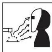
**Boogstralen:** schadelijk voor de ogen en huid van mensen. Boogstralen van de las-/snijproces produceert intense zichtbare en onzichtbare ultraviolette en infrarode stralen die ogen en huid kunnen verbranden. Altijd draag een lashelm met de juiste tint filterlens en geschikte beschermende kleding, waaronder las handschoenen, terwijl de
