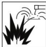
**Rischio di incendio.** Saldatura/taglio su contenitori chiusi, come serbatoi, fusti o tubi, possono farli esplodere. Le scintille volanti dall'arco di saldatura/taglio, dal pezzo caldo e dall'attrezzatura calda può causare incendi e ustioni. Il contatto accidentale dell'elettrodo con gli oggetti metallici possono causare scintille, esplosioni, surriscaldamento o incendi.
