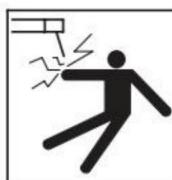
Porażenie prądem: Może spowodować śmierć. Dotknąć cieczą elektrycznych pod napięciem może spowodować śmiertelne wstrząsy lub poważne oparzenia. Elektroda i praca obwód jest pod napięciem elektrycznym zawsze, gdy wejście jest włączone. Wejście obwody zasilania i wewnętrzne trzne obwody maszyny są również pod napięciem, gdy zasilanie jest włączone. W spawaniu MIG/MAG drut, rolki napędu, drut
