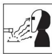
**Bågstrålar:** skadligt för människors ögon och hud. Bågstrålar från svets-/skärningsprocessen producerar intensivt synligt och osynligt ultravioletta och infraröda strålar som kan bränna ögon och hud. Alltid bär en svetshjälm med korrekt nyans av filterlinsen och lämpliga skyddskläder inklusive svetshandskar medan svets/skärning utförs. • Åtgärder bör vidtas för att skydda människor i eller nära det omgivande arbetet
