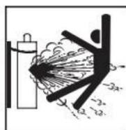
**Gascylindrar.** Skyddsgasflaskor innehåller gas under hög tryck. Om den är skadad kan en cylinder explodera. För gas cylindrar är normalt en del av svets/skärningsprocessen, se till att behandla dem noggrant. CYLINDRAR kan explodera om skadad.
