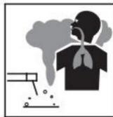
Les fumées et les gaz sont dangereux. La fumée et le gaz générés tandis que le soudage ou la découpe peuvent être nocifs pour la santé des personnes. Le soudage produit des fumées et des gaz. Respirer ces fumées et Les gaz peuvent être dangereux pour la santé. Ne respirez pas la fumée et le gaz généré pendant le soudage ou la découpe, gardez la tête hors de les fumées
