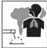
**Dampen en gassen zijn gevaarlijk.** Rook en gas gegenereerd terwijl lassen en snijden schadelijk kunnen zijn voor de gezondheid. Lassen produceert dampen en gassen. Het inademen van deze dampen en gassen kunnen gevaarlijk zijn voor uw gezondheid. Adem de rook niet in en gas dat vrijkomt bij het lassen of snijden, houd uw hoofd er dan uit
