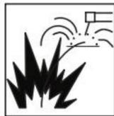
Risque d'incendie. Soudage/coupage sur des conteneurs fermés, tels que réservoirs, fûts ou tuyaux, peuvent les faire exploser. Des étincelles volantes de l'arc de soudage/coupe, de la pièce à travailler chaude et de l'équipement chaud peuvent provoquer des incendies et des brûlures. Le contact accidentel de l'électrode avec
