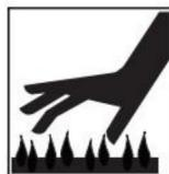
**Heiße Teile.** Beim Schweißen/Schneiden entstehen hohe Temperaturen und diese bleiben erhalten. und kann schwere Verbrennungen verursachen. Berühren Sie heiße Teile nicht mit bloßen Händen. Warten Sie eine Abkühlzeit vor Arbeiten an der Schweiß-/Schneidpistole. Verwenden Sie isolierte Handschuhe und Kleidung zum Umgang mit heißen Teilen und zum Schutz vor Verbrennungen.
