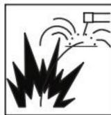
**Brandrisk.** Svetsning/skärning på slutna behållare, som t.ex tankar, trummor eller rör kan få dem att explodera. Flygande gnistor från svets-/skärbågen, hett arbetsstycke och varm utrustning kan orsaka bränder och brännskador. Oavsiktlig kontakt av elektrod till metallföremål kan orsaka gnistor, explosion, överhettning eller brand.
