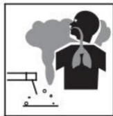
**Fumi e gas sono pericolosi.** Fumo e gas generati mentre la saldatura o il taglio possono essere dannosi per la salute delle persone. La saldatura produce fumi e gas. Respirare questi fumi e i gas possono essere pericolosi per la salute. Non respirare il fumo e gas generati durante la saldatura o il taglio, tenere la testa fuori i fumi
