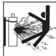
**Gasflaschen.** Schutzgasflaschen enthalten Gas unter hohem Druck. Bei Beschädigung kann eine Flasche explodieren. Da Gas Zylinder sind normalerweise Teil des Schweiß-/Schneidprozesses, Gehen Sie vorsichtig damit um. Zylinder können explodieren, wenn beschädigt.
