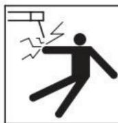
Descarga eléctrica: puede matar. Tocar piezas eléctricas activas puede provocar descargas eléctricas fatales o quemaduras graves. El electrodo y la pieza de trabajo El circuito está activo eléctricamente siempre que la salida esté activa. La entrada El circuito de alimentación y los circuitos internos de la máquina también están activos cuando La alimentación está encendida. En la soldadura MIG/MAG, el alambre, los rodillos impulsores, el alambre
