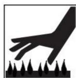
**Parti calde.** Gli elementi saldati/tagliati generano e trattengono calore elevato e può causare gravi ustioni. Non toccare le parti calde a mani nude. Lasciare raffreddare per un periodo prima di lavorare sulla pistola per saldatura/taglio. Utilizzare saldatrici isolate guanti e indumenti per maneggiare parti calde ed evitare ustioni.
