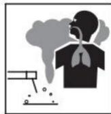
Los humos y gases son peligrosos. El humo y los gases generados Mientras que soldar o cortar puede ser perjudicial para la salud de las personas. La soldadura produce humos y gases. Respirar estos humos y gases puede ser perjudicial. Los gases pueden ser peligrosos para la salud. No respire el humo. y los gases generados al soldar o cortar, mantenga la cabeza alejada
