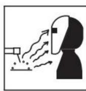
**Raggi ad arco:** dannosi per gli occhi e la pelle delle persone. I raggi ad arco provenienti dal processo di saldatura/taglio producono intensi effetti visibili e invisibili raggi ultravioletti e infrarossi che possono bruciare occhi e pelle. Sempre indossare un casco da saldatura con la giusta tonalità di filtro della lente e indumenti protettivi adatti, compresi guanti da saldatura, mentre viene eseguita un'operazione di saldatura/taglio. •
