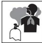
contenuto di ossigeno nell'aria che causa morte o lesioni. Molti gas l'uso in saldatura/taglio sono invisibili e inodori. • Chiudere l'alimentazione del gas di protezione quando non in uso. • Ventilare sempre gli spazi ristretti o utilizzare aria compressa approvata respiratore.
