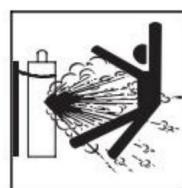
Cilindros de gas. Los cilindros de gas protector contienen gas a alta presión. presión. Si se daña, un cilindro puede explotar. Porque el gas Los cilindros normalmente son parte del proceso de soldadura/corte. Asegúrese de tratarlos con cuidado. Los CILINDROS pueden explotar si dañado.
