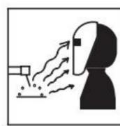
**Lichtbogenstrahlen:** schädlich für Augen und Haut. Lichtbogenstrahlen aus dem Schweiß-/Schneidprozess erzeugt intensive sichtbare und unsichtbare Ultraviolette und infrarote Strahlen, die Augen und Haut verbrennen können. Tragen Sie einen Schweißhelm mit der richtigen Filtertönung und geeignete Schutzkleidung einschließlich Schweißerhandschuhen während der Schweiß-/Schneidarbeiten durchgeführt werden. • Es müssen Maßnahmen zum Schutz von Personen im oder in der Nähe des umliegenden
