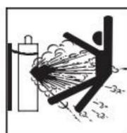
Butle z gazem. Butle z gazem osłonowym zawierają gaz pod wysokim ciśnieniem ciśnienie. W przypadku uszkodzenia cylinder może eksplodować. Ponieważ gaz cylindry są zazwyczaj częścią procesu spawania/cięcia, pamiętaj, aby obchodzić się z nimi ostrożnie. CYLINDRY mogą eksplodować, jeśli uszkodzony.
