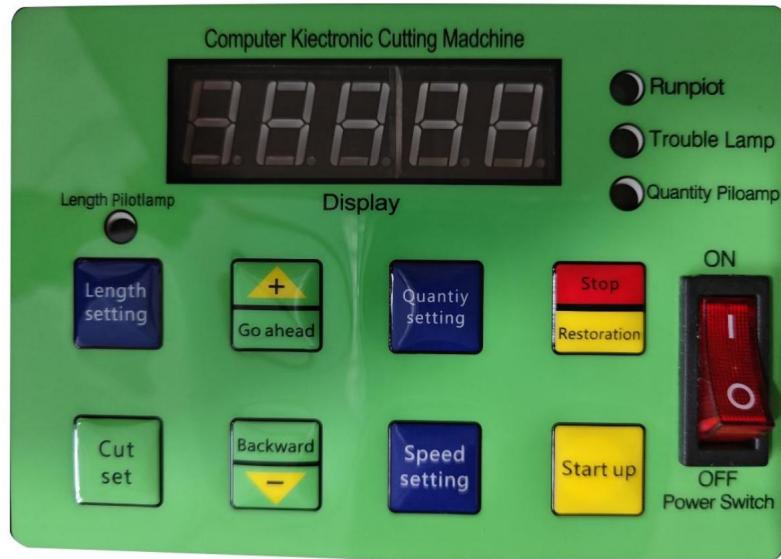
Wyłącznik zasilania: Ten klawisz steruje wyłącznikiem zasilania
