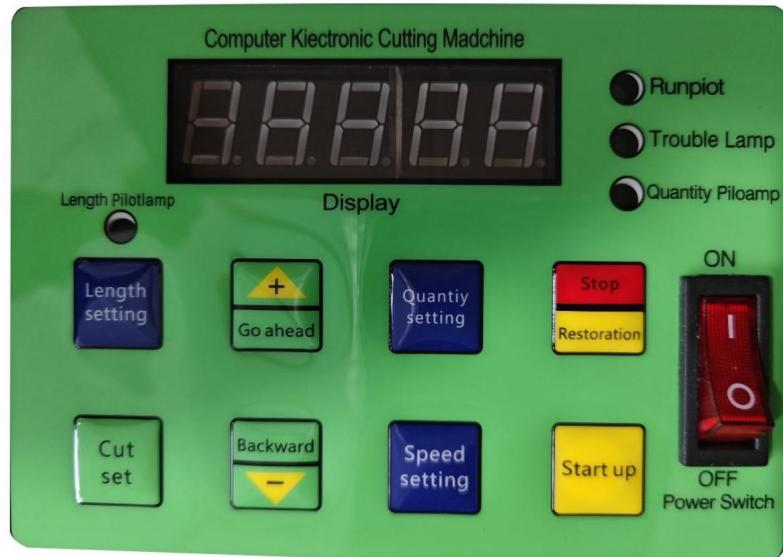
Interrupteur d'alimentation : cette touche contrôle l'interrupteur d'alimentation
