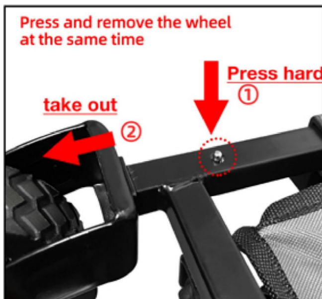
Demontaż tylnego koła.
